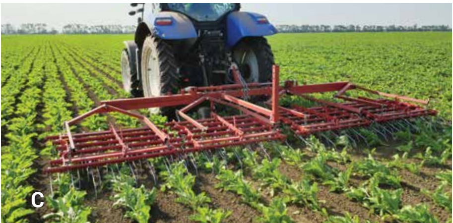
Suzbijanje korova međurednim kultivatorom sa dodacima u vidu rotirajućih zvezdi (A) i češljastom drljačom (B i C)
